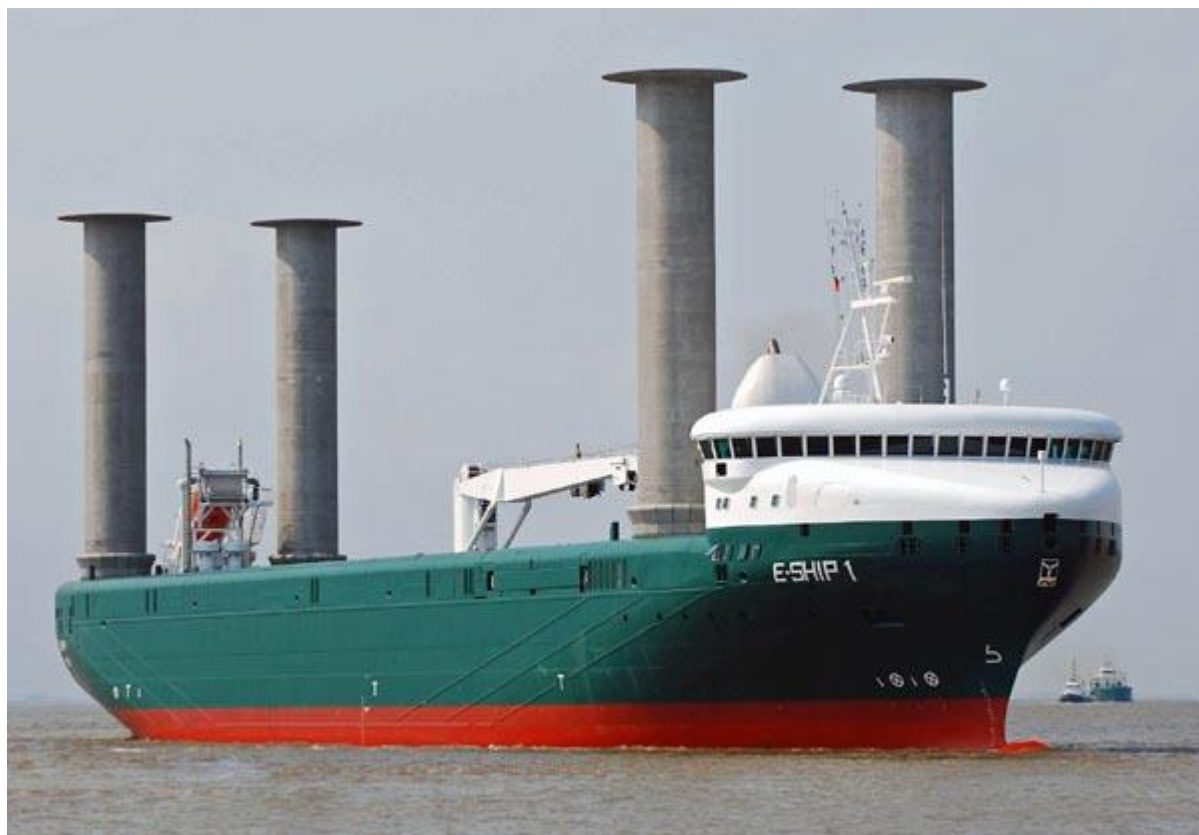
Рис. 5. На палубе E-Ship 1 установлены четыре 27-метровых ротора Флеттнера
