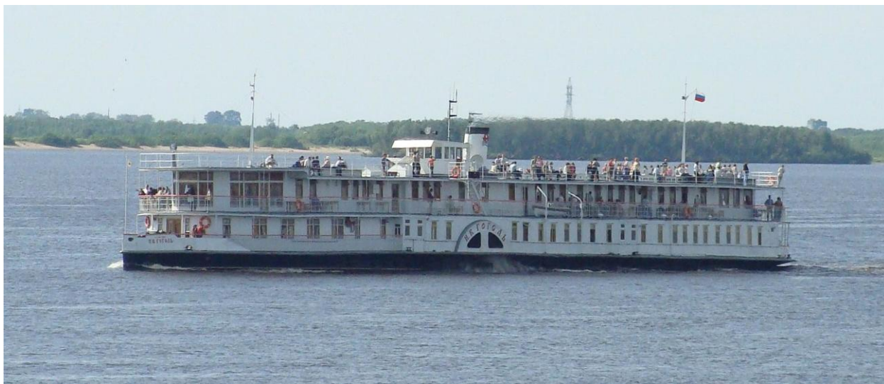
Рис. 1. Пароход «Н. В. Гоголь» — старейшее (1911 г.) российское пассажирское судно, находящееся в эксплуатации (2014 г.) Двигатель — два бортовых колеса.
